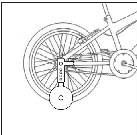
3.a. Posicione a haste superior encaixando a trava lateral no quadro.
