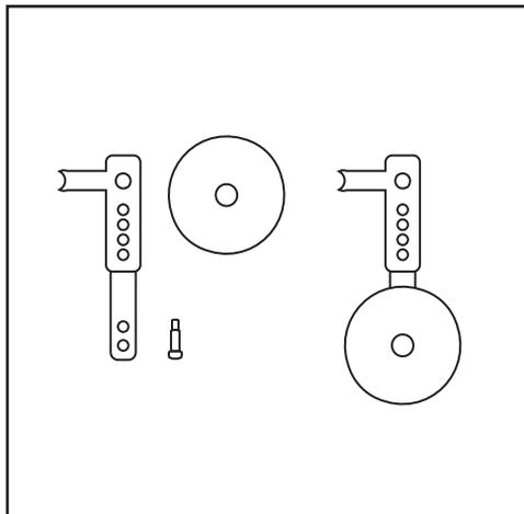
2. Prenda a roda com o parafuso fornecido, podendo ser ajustado pelo 1º ou 2º furo conforme o modelo da sua bicicleta.
