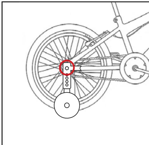
4. Ajuste o comprimento da haste conforme o modelo de sua bicicleta.
