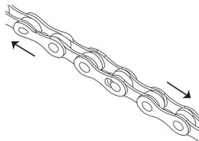
3. Com o engate rápido em mãos, atravesse com os pinos os elos da corrente em ambos os lados e exerça força para que os pinos se posicionem no eixo. Caso necessário use um alicate de instalação de correntes ou exerça força com o movimento da pedivela.
