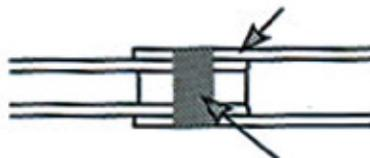
6. O pino conector deverá ser fixado simetricamente, ficando aparente na mesma medida para ambos os lados.
