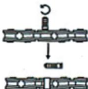
5. Inicie o movimento de inserção do pino conector girando a chave até que ele atravesse a face oposta da corrente, não ultrapassando a face de entrada.
