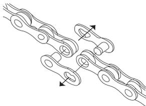
1. Junto à corrente está o engate rápido. Esta peça consiste em duas placas em formato de elo que se encaixam fixando a corrente pelos pinos conectores.
