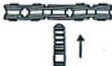
3. Com uso de uma chave de correntes, posicione as duas extremidades no compartimento de instalação.
